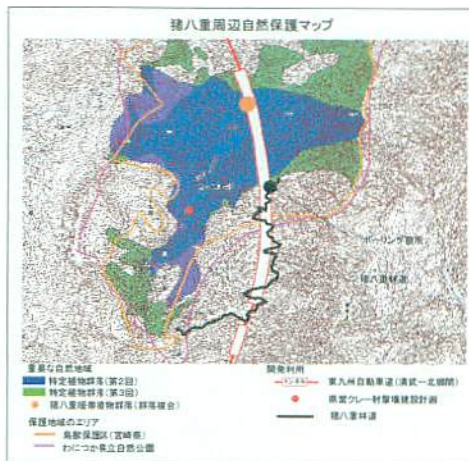
図1 SISPAによる情報表示の例 宮崎県のわか県立自然保護公園のエリア内で重要な群落が広がる地域を縦断する形で高速道路の予定路線が計画されている。こうした情報に基づいて九州地方整備局などに働きかけを行いトンネルにより回避される計画へ変更された。
