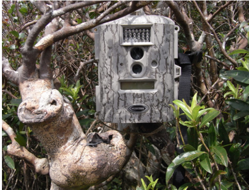
写真2 赤外線センサー付自動撮影カメラの設置状況
