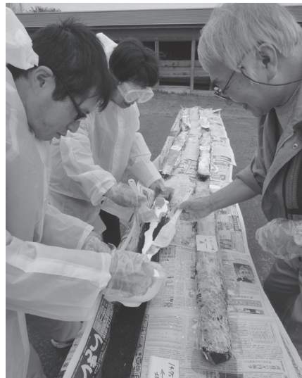
写真3 住民参加による剥ぎ取り標本の作製風景。溶剤は水と混合することで固化する。安全のため、防護メガネやカップパ（いずれも100円ショップで購入）を着用している参加者もいる。
