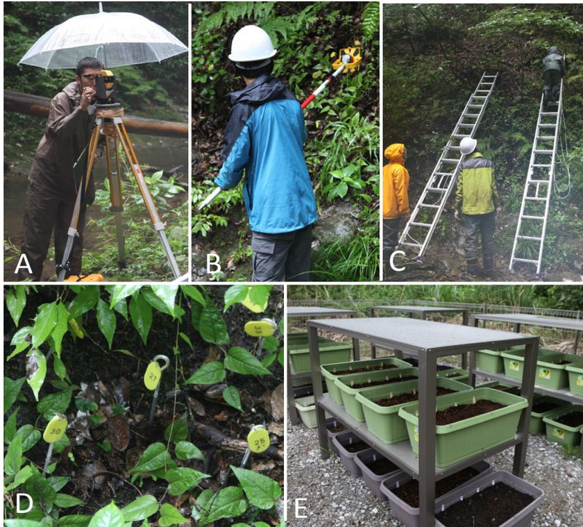
図5 イスミスズカケ自生地調査と域外保全株作成. A, B; トータルステーションを用いた自生地株の位置情報取得. C; 自生地の崖に登り調査・採集をおこなった. D; 自生地各個体につけた個体番号, 錆びにくく経年劣化の少ない材料を用いた. E; 測量により得られた自生地株位置の立体図(一部抜粋)
