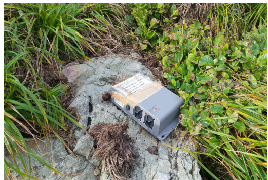
図4 ソングメーター設置状況
