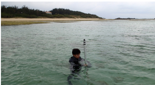
図3 調査地域における地形測量の様子。奄美大島の調査測線において測量尺を用いて水深を計測している
