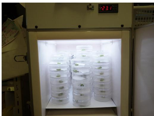
図3 室内実験での様子。収納庫は時間調整照明機能付きのインキュベーター (プラントステーション LED3 : バイオメディカルサイエンス社製)。
